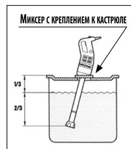
Во избежание разбрызгивания убедитесь, что насадка хорошо погружена в продукт, а вентиляционные отверстия блока двигателя не соприкасаются с жидкостью.
