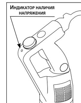
**Исключительно для машин 120 В / 60 Гц: зелёный индикатор загорается не в момент подключения аппарата к сети, а только в момент нажатия на кнопку управления (BC).**
